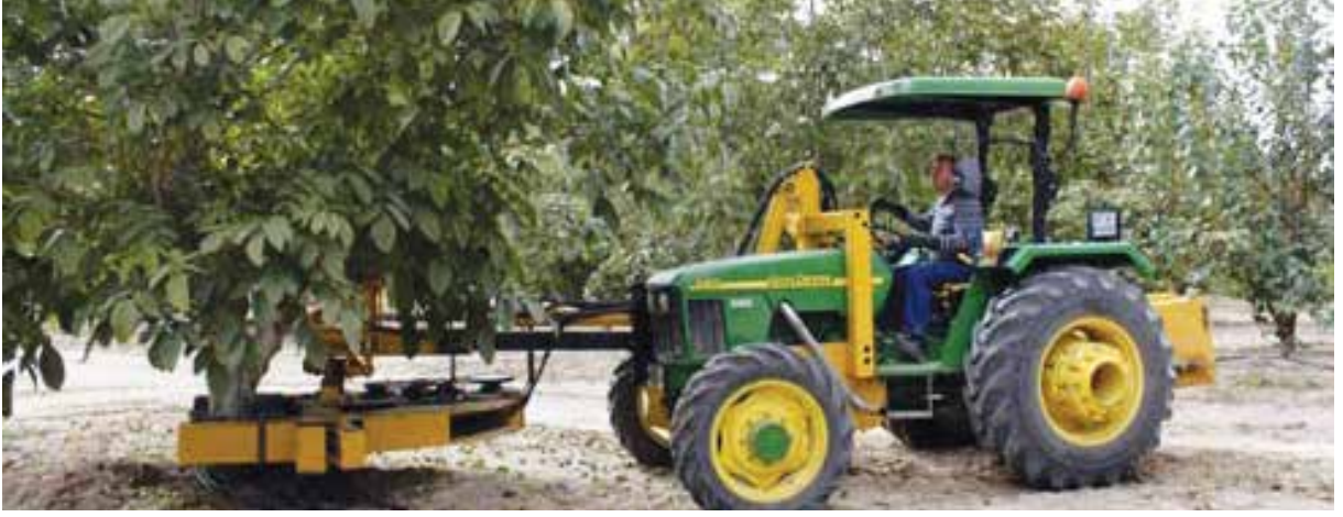
Şekil 35. Türkiye’de ilk kez yapılan ‘Ağaç sallama makinesi’, bir işçinin 8 saatte yaptığı ceviz silkme işini, 1 dakikada gerçekleştiriyor.
