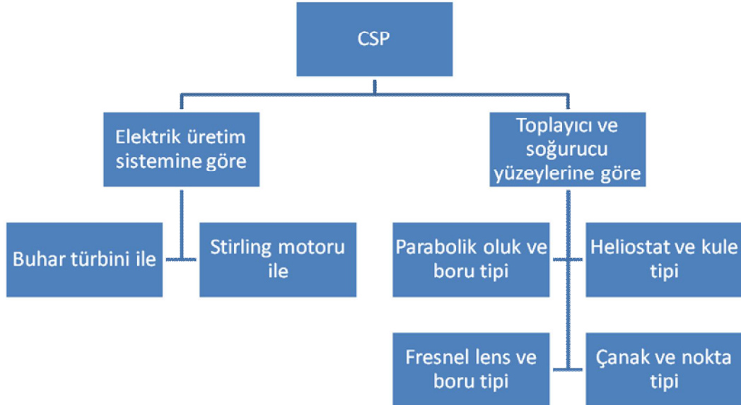
Şekil 24. Elektrik üretimi açısından yoğunlaştırılmalı sistemlerin sınıflandırılması
