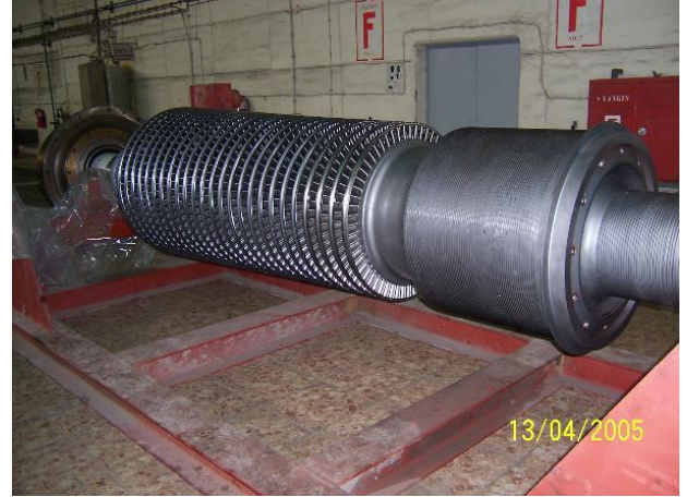
Şekil 45. Kumlanmış YB Türbin Rotoru
