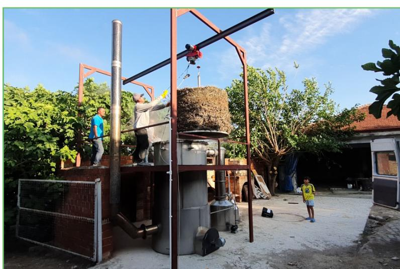
Şekil 18. Adaçayı uçucu yağ üretiminde kullanılan buharlı veya alttan yakmalı distilasyon kazanları
