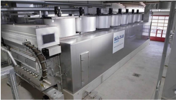
Resim 4.58. Dünya uygulamalarında gübrenin kurutulması için kullanılan örnek bir kurutucu
