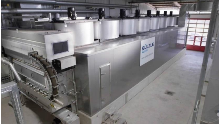
Resim 4.38. Dünya uygulamalarında gübrenin kurutulması için kullanılan örnek bir kurutucu
