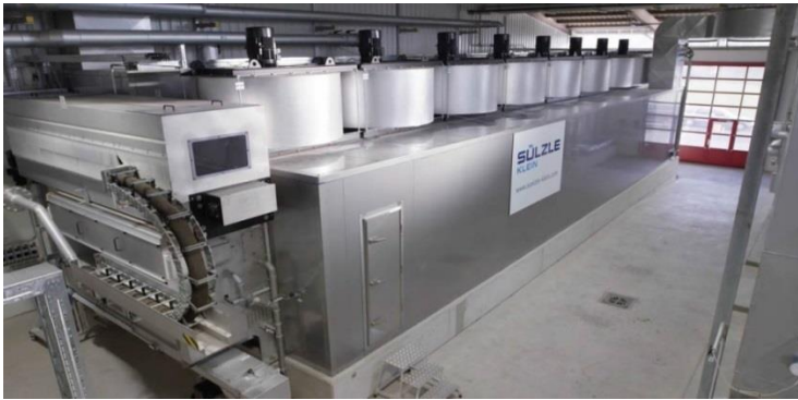
Resim 4.42. Dünya uygulamalarında gübrenin kurutulması için kullanılan örnek bir kurutucu
