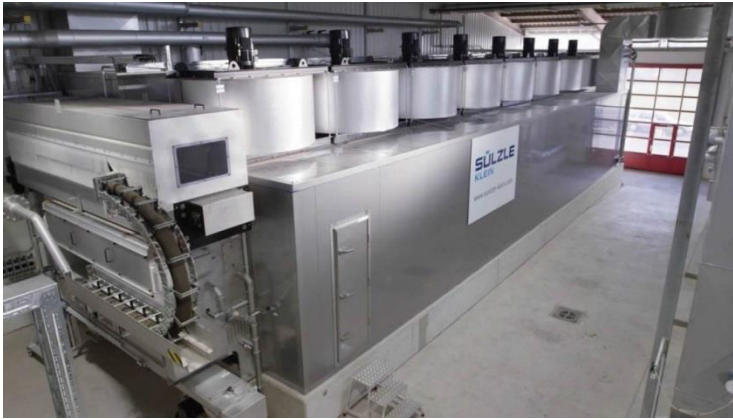
Resim 4.30. Dünya uygulamalarında gübrenin kurutulması için kullanılan örnek bir kurutucu
