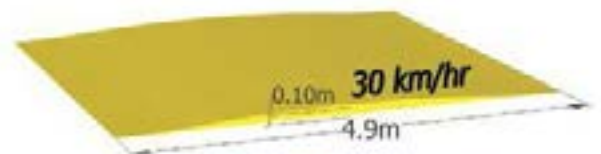
Şekil 86 Önerilen yükseltilmiş hız kesici tümsek tasarımı (EMBARQ, 2015)
