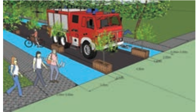
Şekil 75 Trakya Üniversitesi Yerleşkesi motorlu taşıt trafiğine kapatılacak güzergâhlar için kavramsal tasarım örneği
