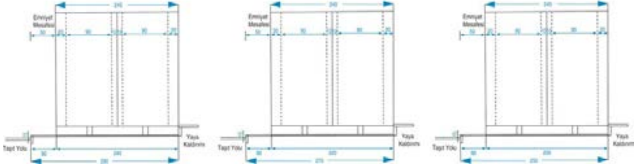
Şekil 78 Yaya kaldırımındaki bisiklet yolunun enkesit ölçüleri (TSE, 2013)
