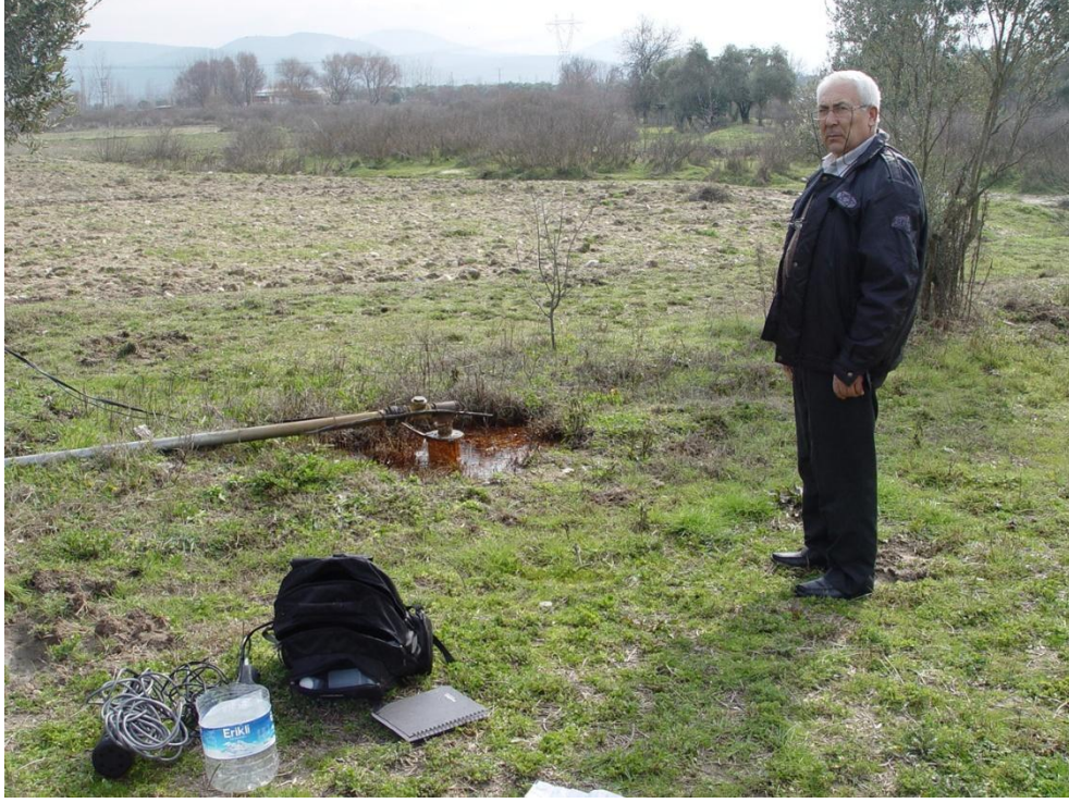
Şekil 4.60 YHS-2 sondaj kuyusu. Bu kuyu da devamlı artezyen yapmaktadır ve borudan tahliye edilmektedir.
