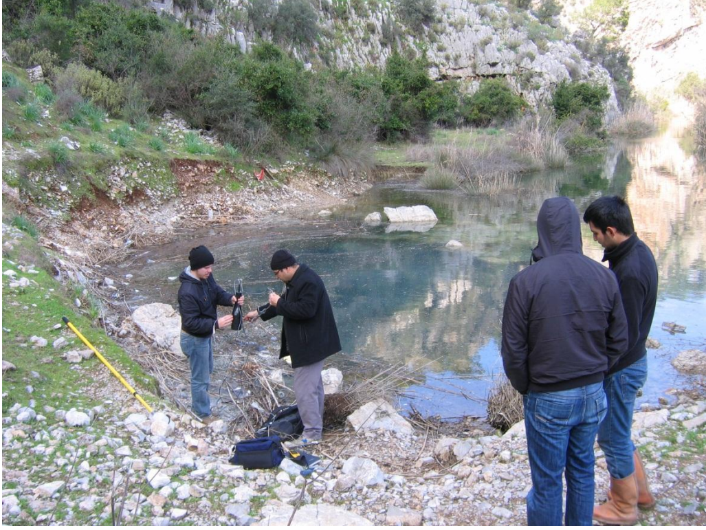
Şekil 4.150 Kelgirme olarak bilinen termal kaynağın genel görünümü (Su kütlesinin örnekleme yapılan kısmında 4-5 adet debisi 1 l/s'nin altında kaynak gözlenmiştir ancak su kütlesinin tabanında da kaynaklar olması muhtemeldir).
