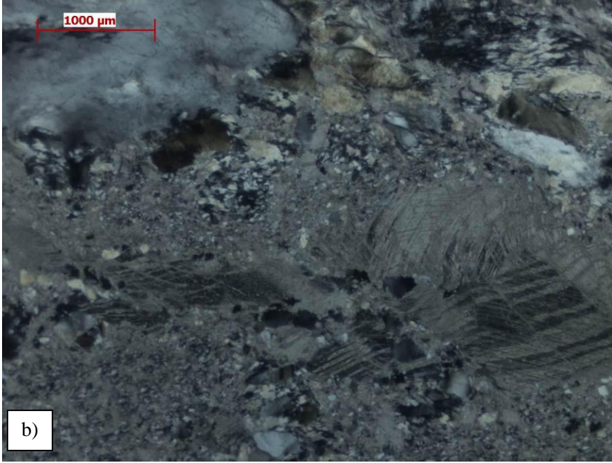
Şekil 4.31 Milas Kırıkkışlacık lokasyonundan derlenen kireçtaşı örneğinin a) el örneği ve b) ince kesit (çift nikol) görüntüsü.
