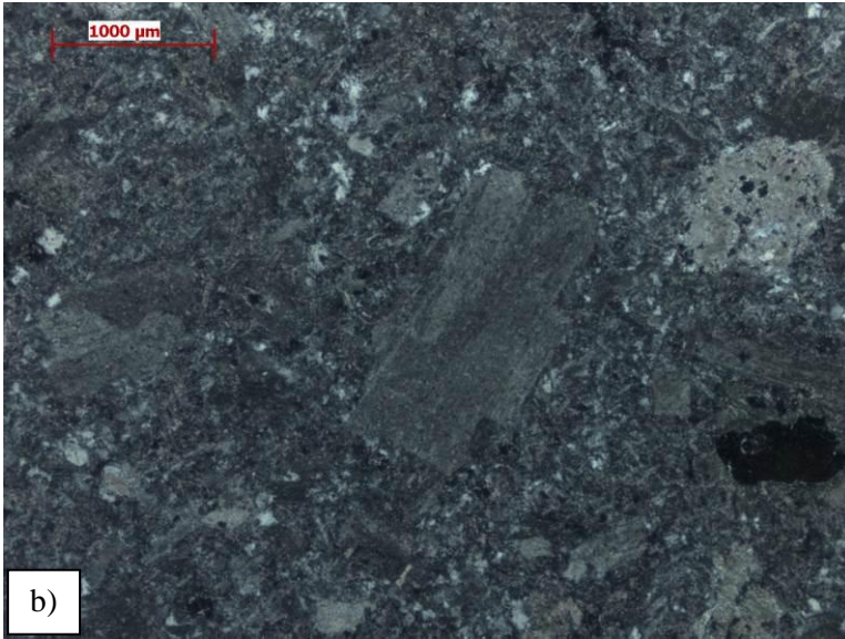
Şekil 4.115 Dereköy lokasyonundan alınan altere volkanik kayacın a) el örneği ve b) fotomikrografında altere plajiyoklaz fenokristalleri, hamurda plajiyoklaz mikrolitleri ve altere mafik mineraller görülmektedir (çift nikol).
