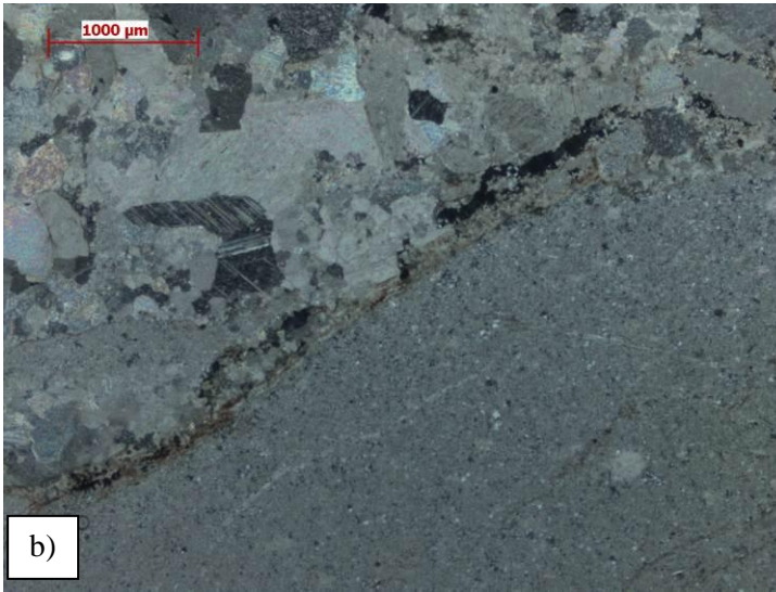
Şekil 4.104 Bodrum Karaada'dan alınan kireçtaşının a) el örneği ve b) ince kesitinin (çift nikol) görüntüsü.
