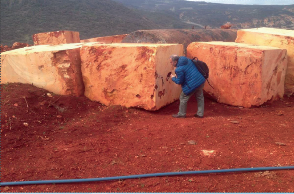
Resim 8. Ruhsat sahası içerisinde özellikle MTA tarafından sürdürülen sondaj çalışmalarının yapıldığı bölgede açık maden işletmeciliği yapılan traverten oluşumları
