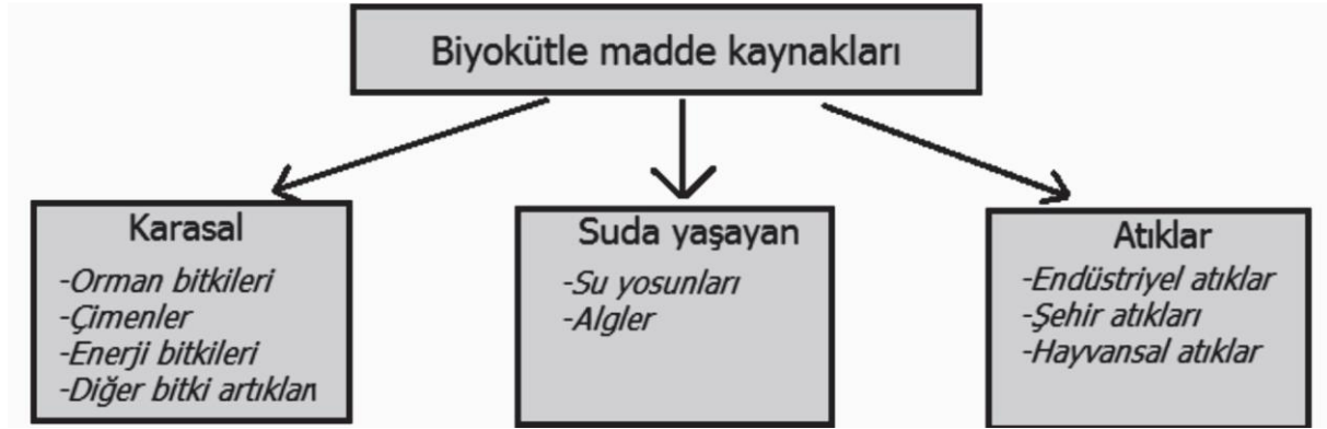
ŞEKİL 2. BİYOKÜTLE MADDE KAYNAKLARININ SINIFLANDIRILMASI 2
