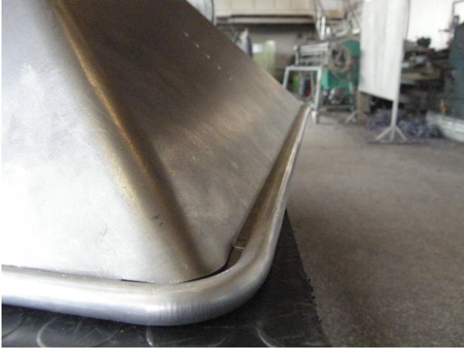
Resim 13 – Sac Davlumbaz, Büküm Detayı
