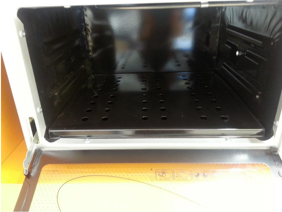
Resim 176 – Mini Fırın, Alt rezistansın Perfore Metal ile Kapatılması
