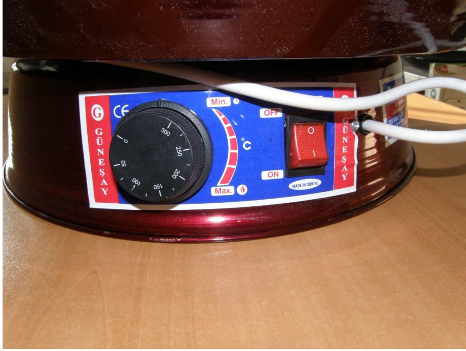
Resim 108 – Katmer Sacı, Kontrol Paneli
