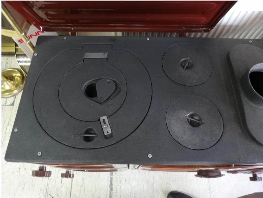
Resim 210 – Soba, Sađ üstteki iki kapak çaydanlık ve benzeri nesnelere oturtmak için kullanılıyor, soldaki iç içe iki kapak ise gerektiğinde farklı açıklıklardan yanma odasına ulaşmaya yardımcı.
