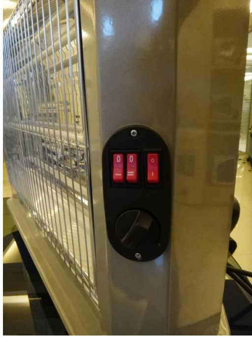
Resim 143 – Elektrikli Isıtıcı, Kontrol Paneli
