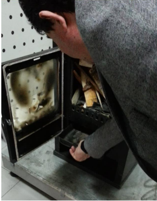
Resim 20 – Kül Boşaltma Haznesinin Çıkarılması
