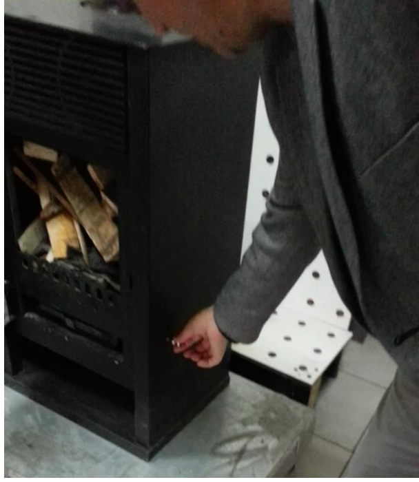
Resim 19 – Sobanın Sönmesinden Sonra Külleri Boşaltma Haznesine Pompalayan Kol
