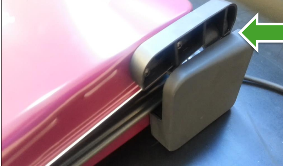
Resim 79 – Plastik Bağlantı Detayı Açık Hali
