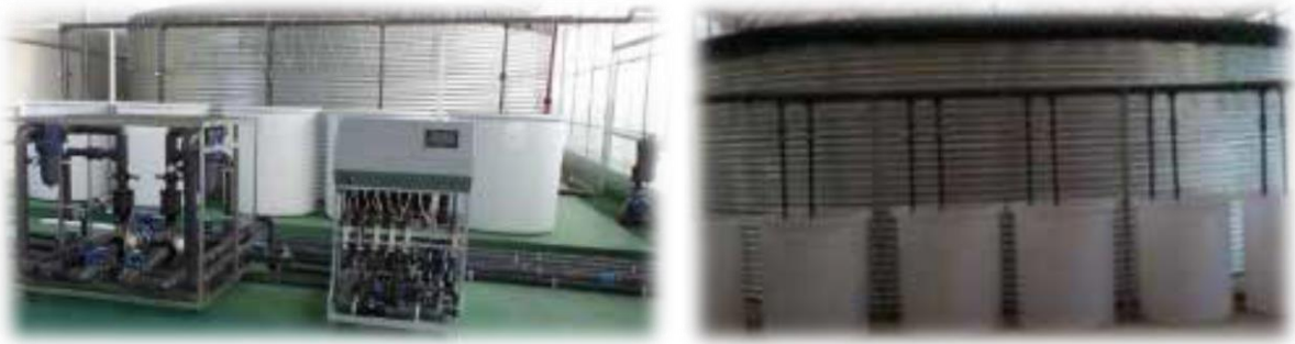
Resim 8: Seralarda Kullanılacak Sulama ve Gübreleme Otomasyonu ve Gübre Tankları
