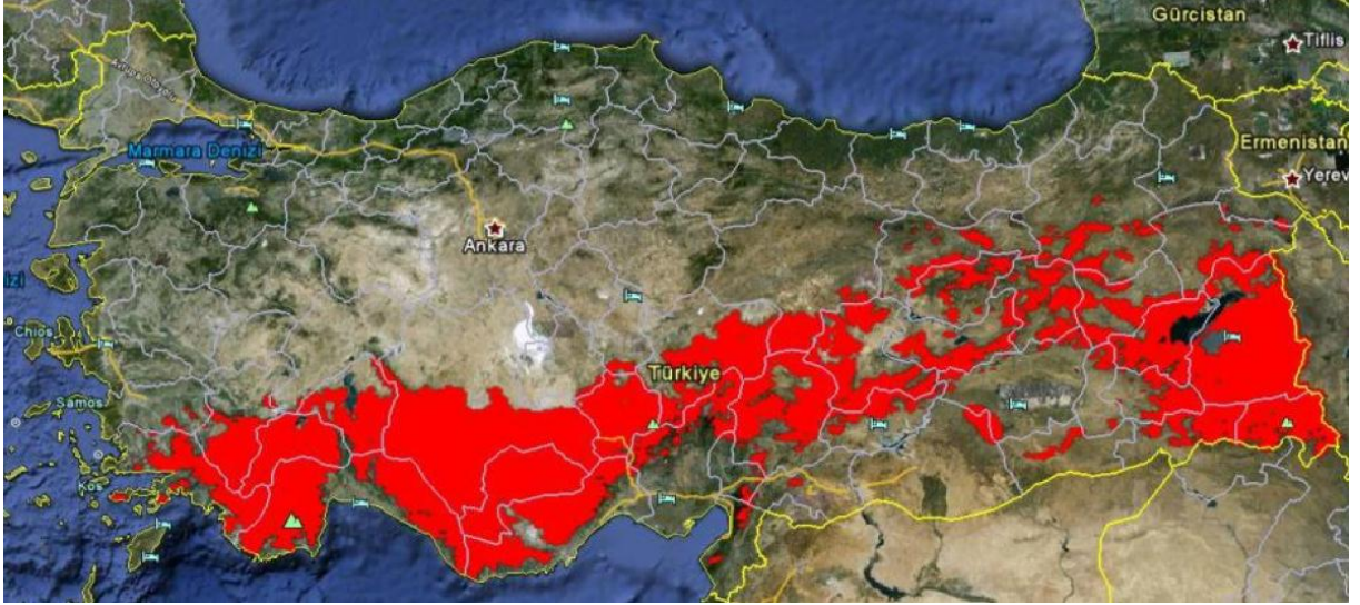
Şekil.8. Yatay Yüzeyle Gelen Toplam Güneş Radyasyon Değeri 1650 kWh/m 2 -yıl'dan Büyük Olan Alanlar [8]
