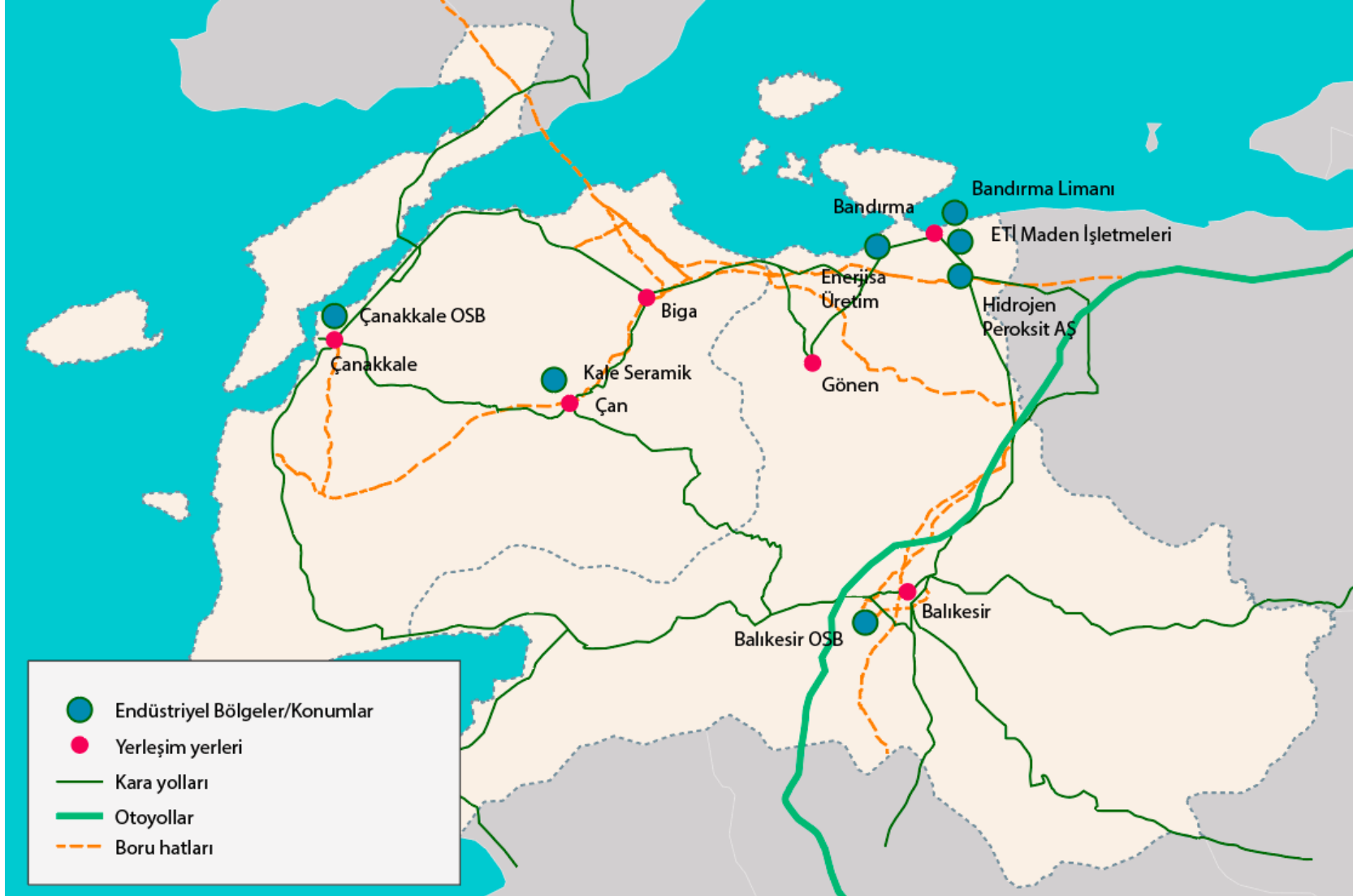
Şekil 49. Balıkesir Ve Çanakkale İl Sınırları İçerisinde Yer Alan Doğalgaz Boru Hatları. Veri Kaynağı: [113]
