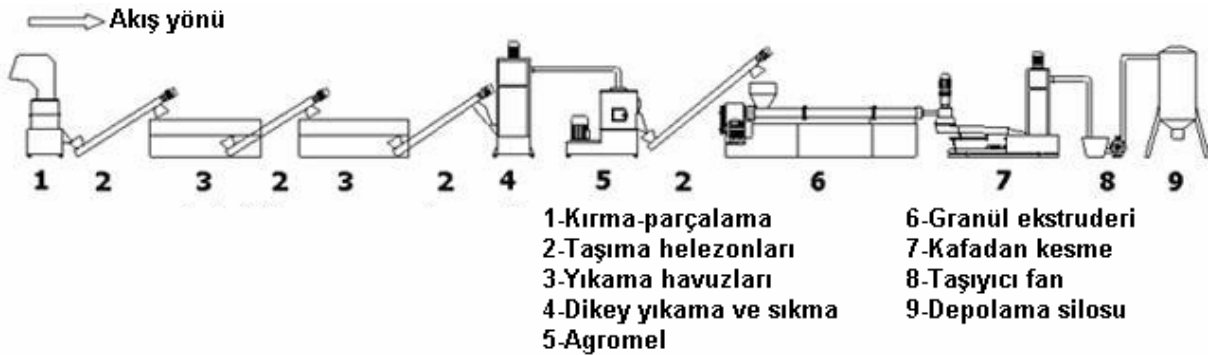
Şekil 1: Geri dönüşüm makinesi üniteleri ve akış şeması
