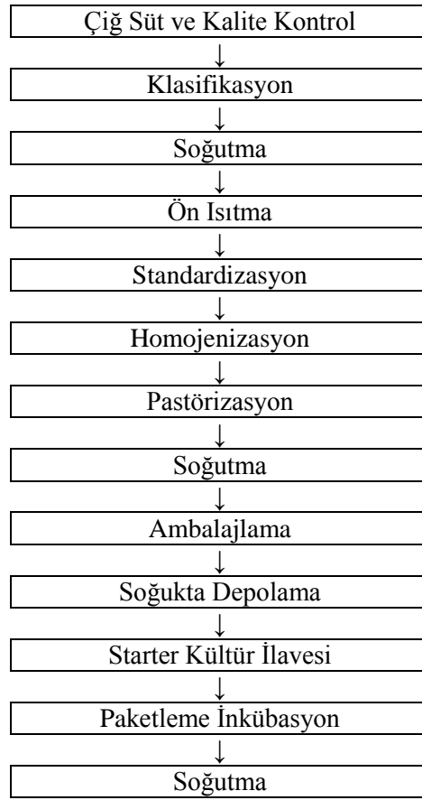
Şekil 3. Yoğurt Ayran İş Akış Şeması
