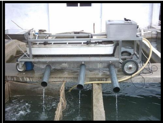
Şekil 24 Tatlısu işletmelerinde yılda birkaç kez yapılan boylama işleminin makine ile yapılması
