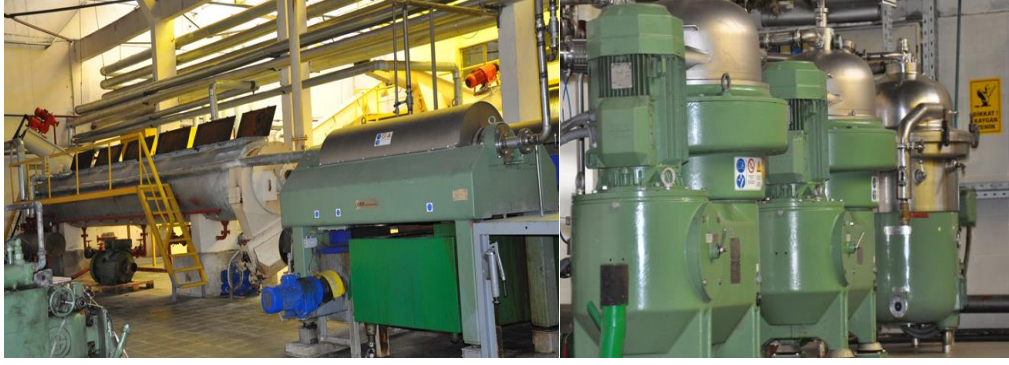
Şekil 49 Hamsinin balık unu ve yağı olarak işlenmesinde pişirme ve öğütme aşamaları.
