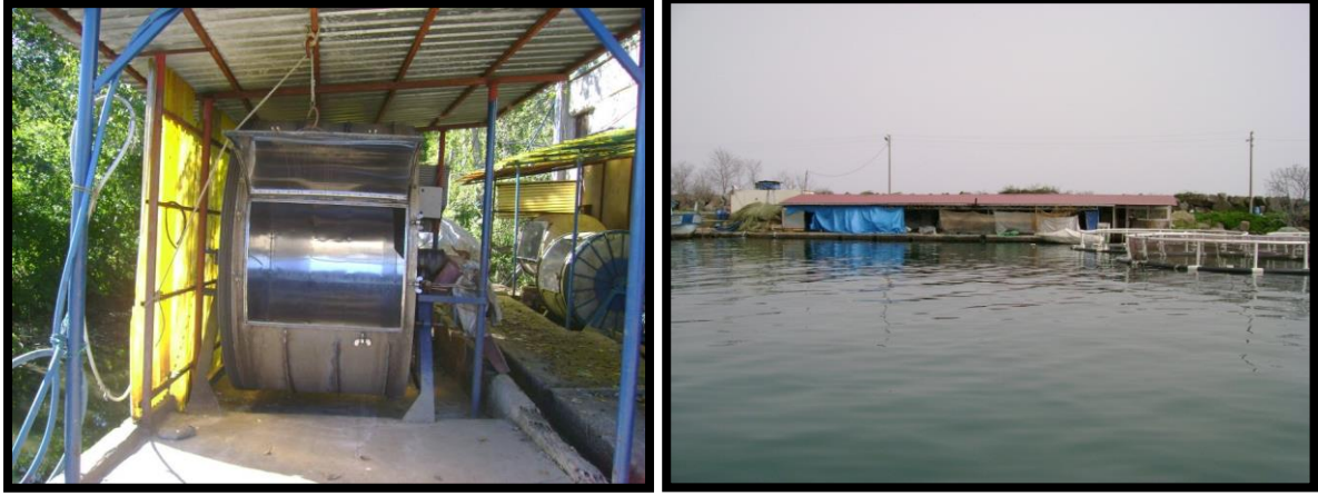
Şekil 25 Ağ kafes işletmeleri kıyı tesisleri liman içlerinde veya balıkçı barınaklarında bulunmaktadır. Bu tesislerde ağların yıkama ve bakımları makine ile yapılmaktadır.
