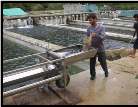
Şekil 24 Tatlısu işletmelerinde yılda birkaç kez yapılan boylama işleminin makine ile yapılması
