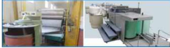
Fotoğraf 17: Yün Elyaf Açma, Yıkama ve Kurutma Tüneli
