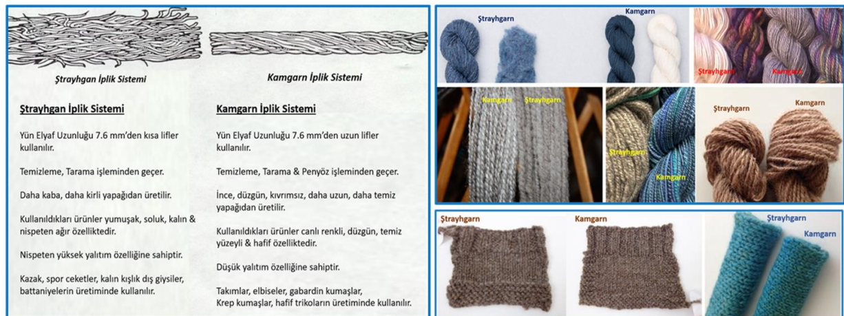
Şekil 5: Kamgarn, Yarı Kamgarn ve Ştrayhgarn İplik Lif Sistemi 19 ve Hazırlanmış Ürünler 20
